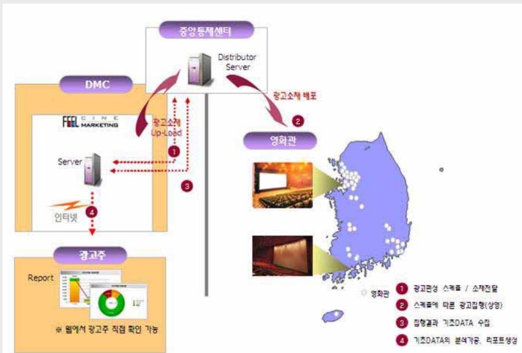
<그림-2> 디지털시네마광고 시스템 흐름도
